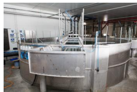
Mynd 6. Stálkar hjá Arctic Smolt sem er 5,5 metrar í þvermál.
