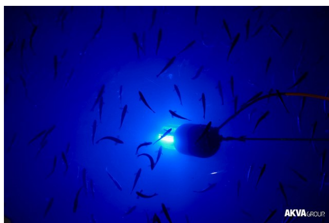
Mynd 9.7. BlueLed ljós í eldiskví (Ljósmynd: www.akvagroup.com).
