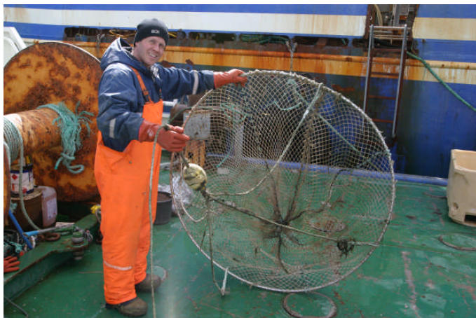
Mynd 4. Séð ofan í dauðfiskaháf hjá HB Granda hf. Í botn háfsins hangir tóg með þynging sem er höfð utan við netpokann (Ljósmynd: Valdimar Ingi Gunnarsson).
