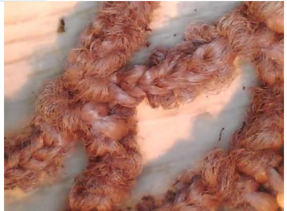
Mynd 1. Vatnsþrýstingurinn gerir að þétt ofið nót línið þófnar og línið þenst út.
